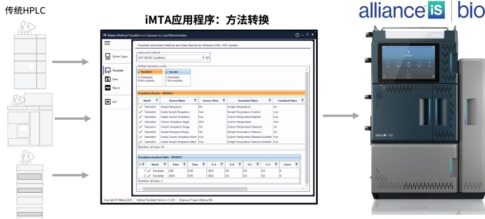
图2.iMTA应用程序可以从多个传统HPLC系统无缝转换方法条件，并将参数转换为 Alliance iS Bio HPLC System方法的参数。
