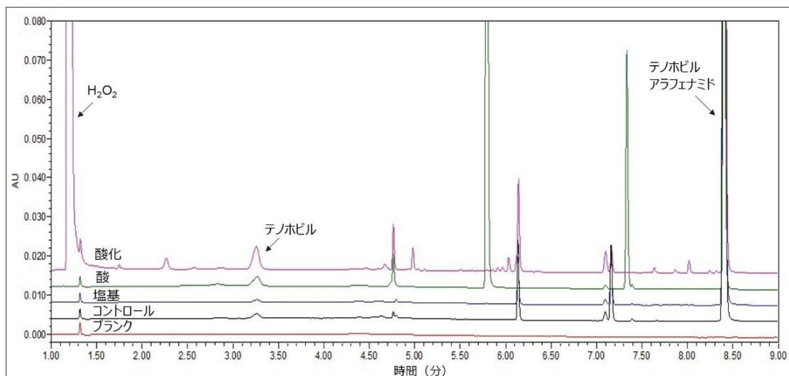
図 4. テノビルアラフェナミドフマル酸塩の強制分解サンプル調製物についての最終的な SIM クロマトグラフィープロファイル
