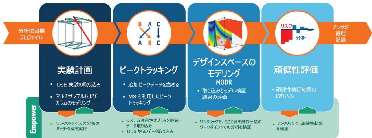
図 2. DryLab-Empower AQbD 分析法開発プロセスに含まれる複数のステップのワークフロー
