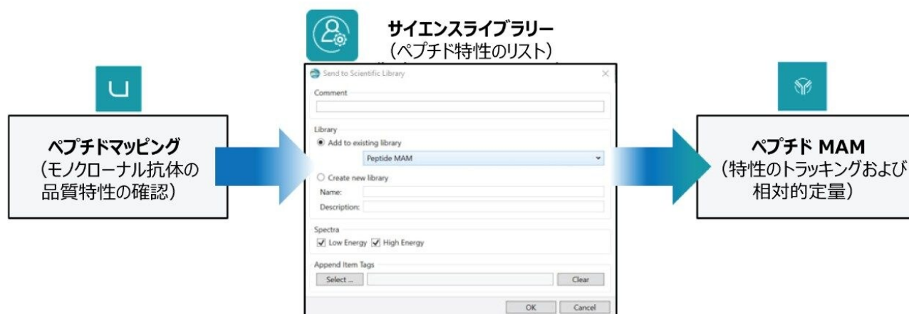
図 1. サイエンスライブラリーは、特性解析アプリケーションとモニタリングアプリケーションの間でペプチドの特性情報を管理するために使用できます。ペプチドマッピング実験で割り当てられたペプチドの特性をライブラリーにエクスポートし、それを用いてペプチド MAM アプリケーションによって特性モニタリング用のターゲットリストを作成できます。
